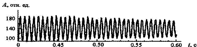
б) Фрагмент рис. 2 а. Наблюдается сильная реверберация (звон), длящаяся несколько секунд и свидетельствующая об аномально высокой добротности блока
